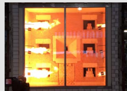
Mock Up Thermische Fassade: Brandtest
